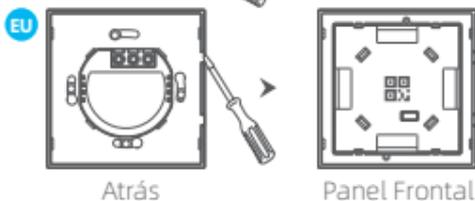
Conecte el cable vivo al terminal L y el cable de retorno al terminal (L1, L2 o L3 según sea el caso).
